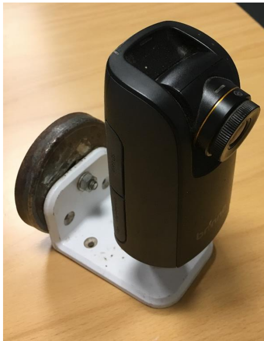
Figur 1 Kameratepe med funktionen "time-laps", monteret på et vinkelbeslag med en kraftig magnet bagpå. Herved let montering ude i staldene.
