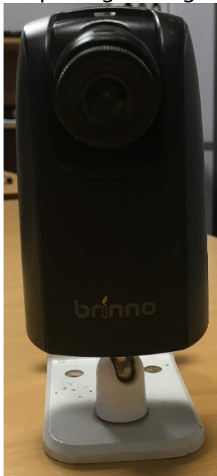
Figur 1 Kameratepe med funktionen "time-laps", monteret på et vinkelbeslag med en kraftig magnet bagpå. Herved let montering ude i staldene.
